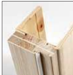
Telaio in listellare e coprifilo multistrato da 9 cm con aletta telescopica. Il traverso del coprifilo ribassato di spessore è in MDF
